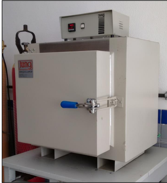
Figura 57: Forno utilizado no tratamento térmico das molas. Fonte própria.
