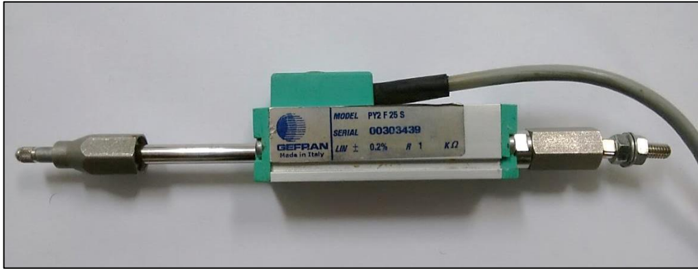
Figura 63: Transdutor de posição GEFRAN modelo PY2-F-25-S. Fonte própria.
