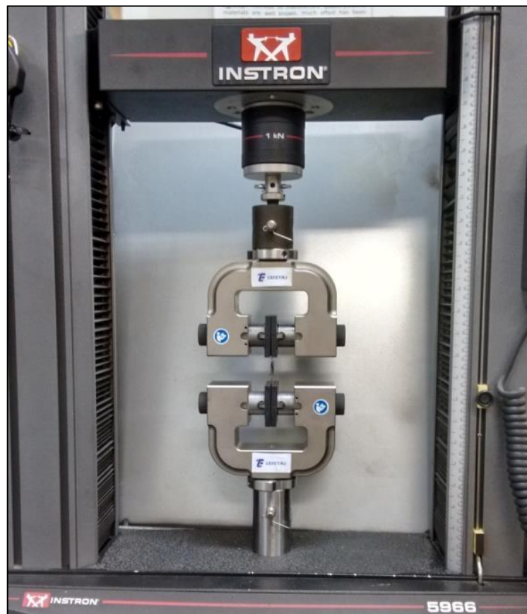
Figura 60: Ensaio de tração da mola M4. Fonte própria.
