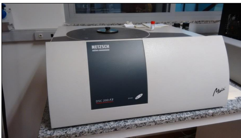
Figura 55: Aparelho Netzsch DSC 200 F3 utilizado na análise térmica. Fonte própria.
