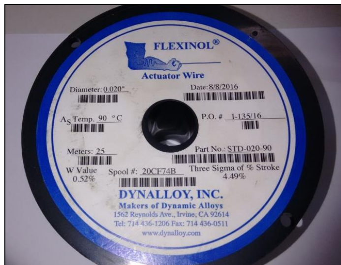
Figura 53: Rolo do fio SMA FLEXINOL® Actuator Wire. Fonte própria.
