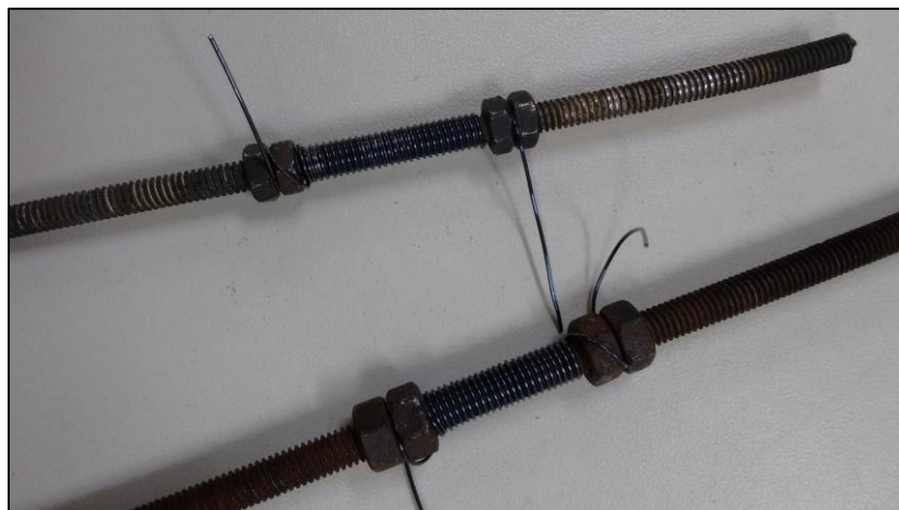
Figura 56: Foto das molas enroladas nos fusos antes de irem para o forno. Fonte própria.
